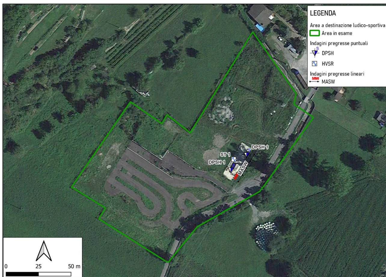
Fig. B1: Ubicazione indagini geofisiche e geognostiche eseguite (Dott. Geol. Filippo Pezzotti).
