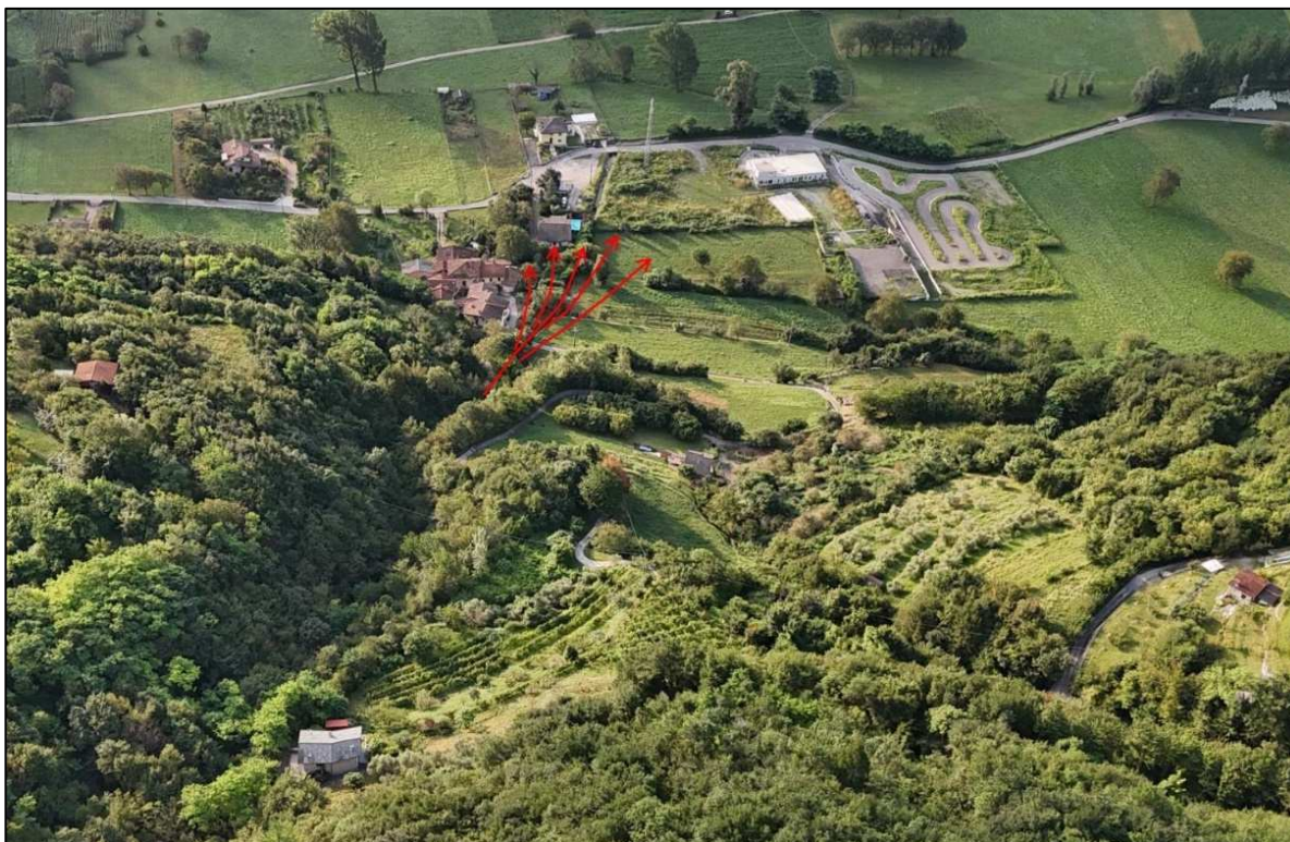
Fig. 56: Immagine da drone della conoide della Valle Corna Marsa, l'abitato di Tezze, l'area in esame e le direttrici di propagazione di un ipotetico debris flow.
