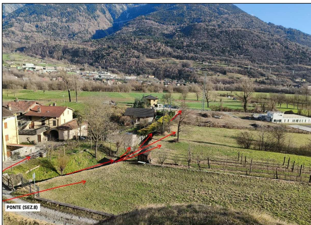
Fig. 57: Vista dell'alveo a monte dal ponte (sezione n. 8) con indicate le potenziali vie di fuga della colata detritica.
